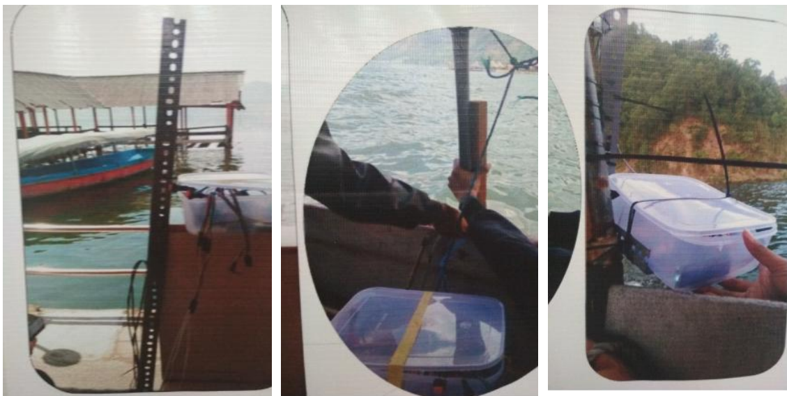
Gambar 3.4 Sensor Pengukur Suhu Permukaan Laut
