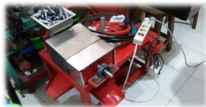
Gambar 3.10 Alat Pemas Kelapa Tipe Ulir
