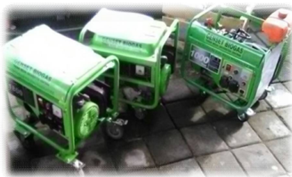
Gambar 3.11 Alat Converter Mesin Genset 4 langkah
